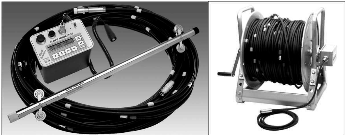
А Б Рис. 1 – Обладнання інклінометричної системи
