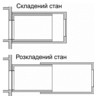
Рис.5. Принципове конструктивне рішення квартири, що має рухому частину
