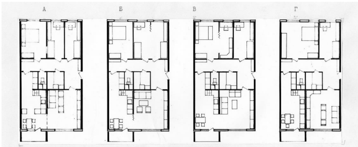
Рис.5. Модифікації житлової чарунки к широким кроком 7,2 м в серії будинків для м. Братислава
