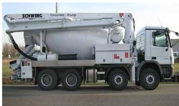
Рис. 10. Автобетонозмішувач з бетононасосом фірми Stetter.
