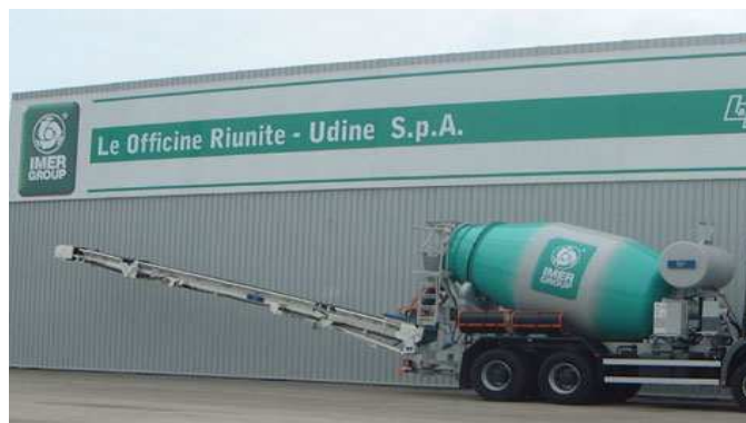
Рис. 11. Автобетонозмішувач з конвеєром фірми IMERGROU.
