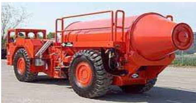
Рис. 9. Змішувач з горизонтальним барабаном фірми Normet.
