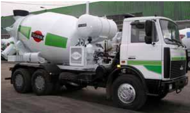
Рис.14. Привод змішувального барабана від автономного двигуна.
