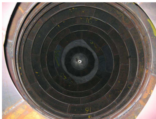
Рис. 5. Т-подібний захист ( 30 \times 8 \text{ мм} ) на поверхні шнека барабанів фірми Stetter.
