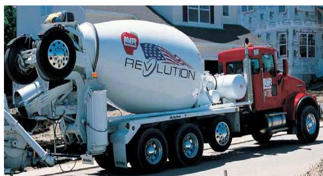
Рис. 13. Автобетонозмішувач з додатковим візком фірми Oshkosh.
