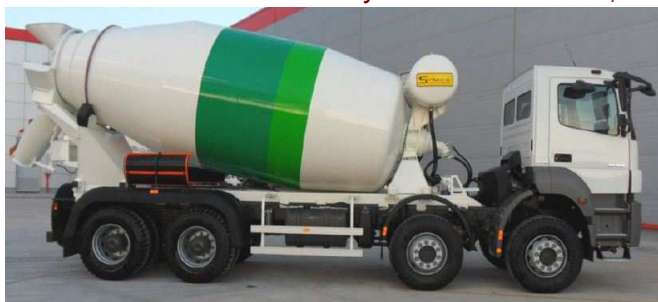
Рис. 3. Автобетонозмішувач із об'ємом 9 \text{ м}^3 .
