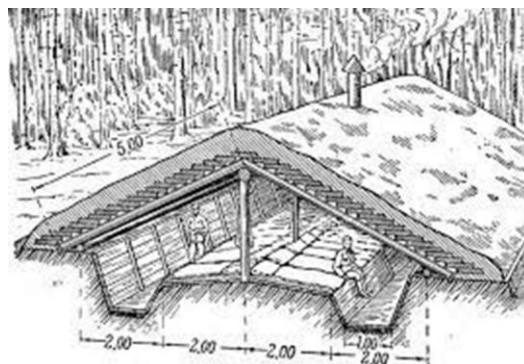
Рис. 18 Конструкція землянки з дерев'яних колод. [30]
