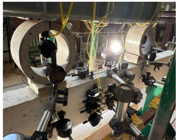
Fig. 3. Placement of the micro-indicators. Рис.3. Схема розташування мікроіндикаторів
