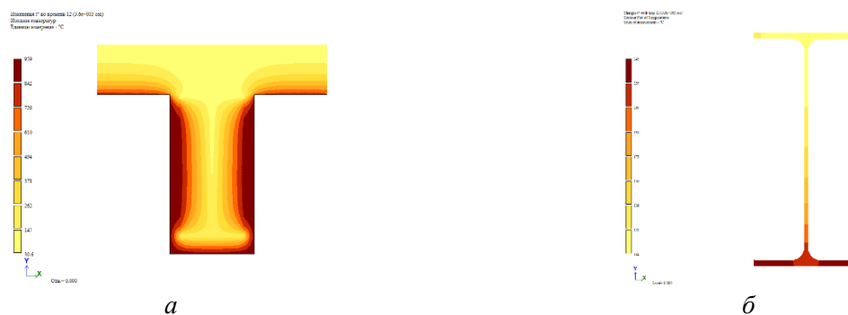
Рис. 7. Розподілення температурних полів в перерізі двотавру із вогнезахистом 25 + 40 мм:
