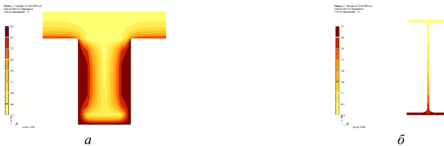
Рис. 5. Розподілення температурних полів в перерізі двотавру із вогнезахистом 40 мм:
