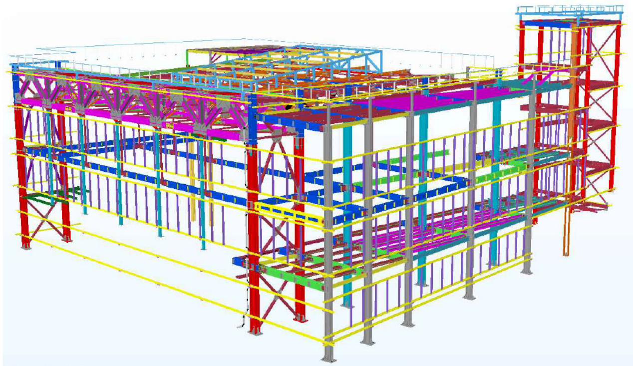
Рис.7. Модель металевого каркасу прибудови після реконструкції з використанням «Tekla Structures» Fig.7. Model of a metal framework of an extension after reconstruction with use of "Tekla Structures"
