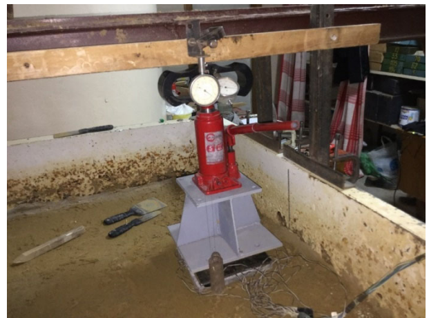
Рис. 3. Модель пальового фундаменту перед випробуванням. Fig.3. Model of the pile foundation before the test.
