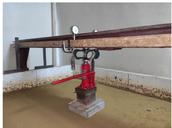
Рис. 4. Модель випробування плити ростверку. Fig.4. Test model of rostwerk plate.
