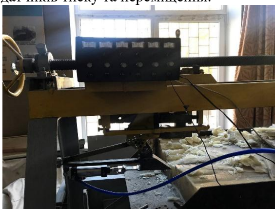
Рис. 1. Лабораторна установка для дослідження процесу різання моделі ґрунту деформатором із ріжучою кромкою на пневмоаккумуляторі
