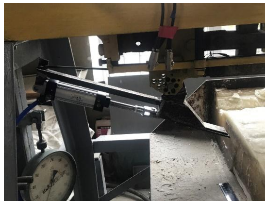
Рис.2. Деформатор з ріжучою кромкою на пневмоаккумуляторі
